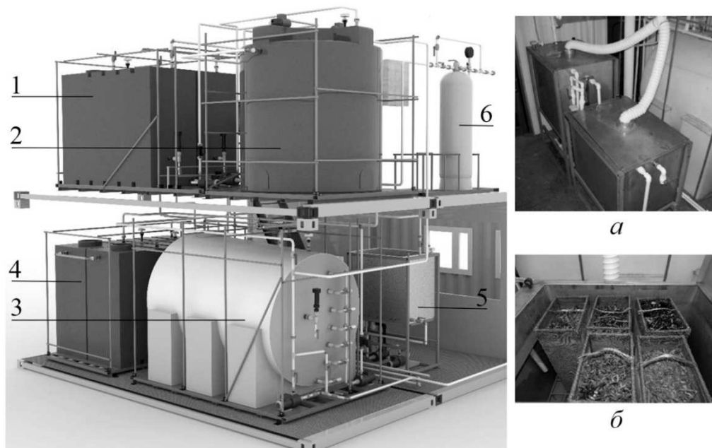
Рис. 1. Опытно-промышленная установка: а – реактор-восстановитель, б – кассеты с активной загрузкой
